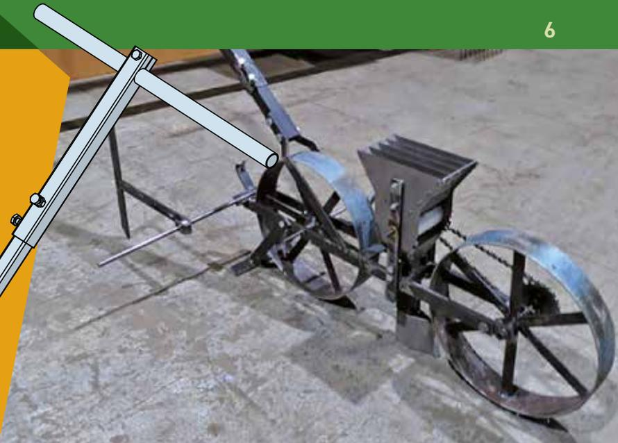
Prototypé pour la première fois en 2020, ce semoir manuel a été développé pour des producteurs de lentilles de Cilaos (île de La Réunion). Les conditions de sols escarpés et difficiles d'accès nécessitaient de mécaniser de manière appropriée les semis.
