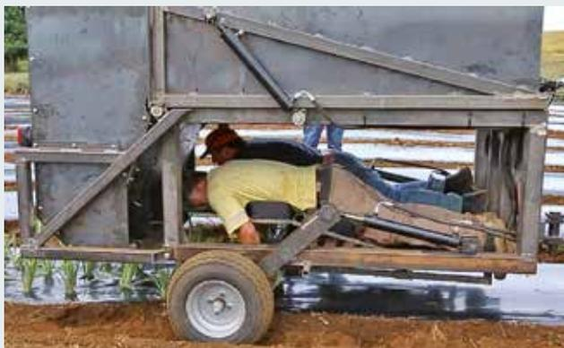
Des vérins hydrauliques double-effet permettent de gérer la hauteur de travail ainsi que l'équilibre de l'outil. Le levage de la benne est, quant à lui, assuré par des vérins simple effet.
