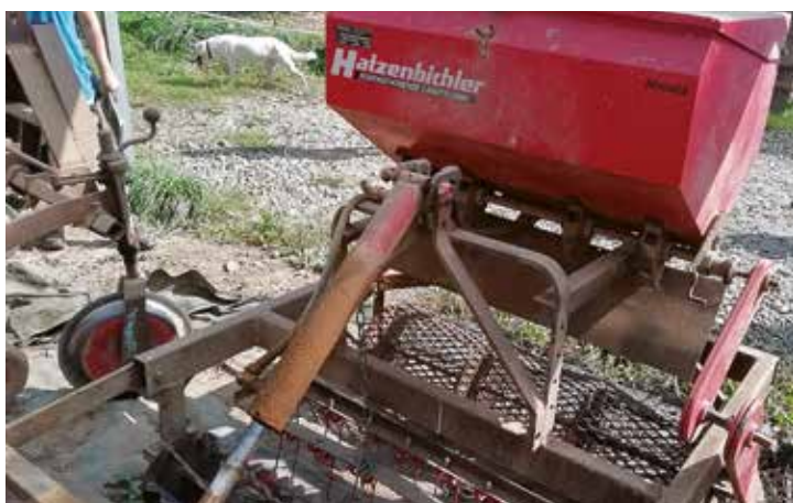
Montage d'une trémie sur un bâti autoconstruit
