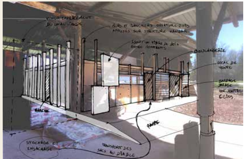
Construction Boulangerie + Local de vente
