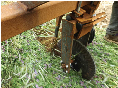
Disque-coudre avec de petites ondulations : coupe le couvert végétal
