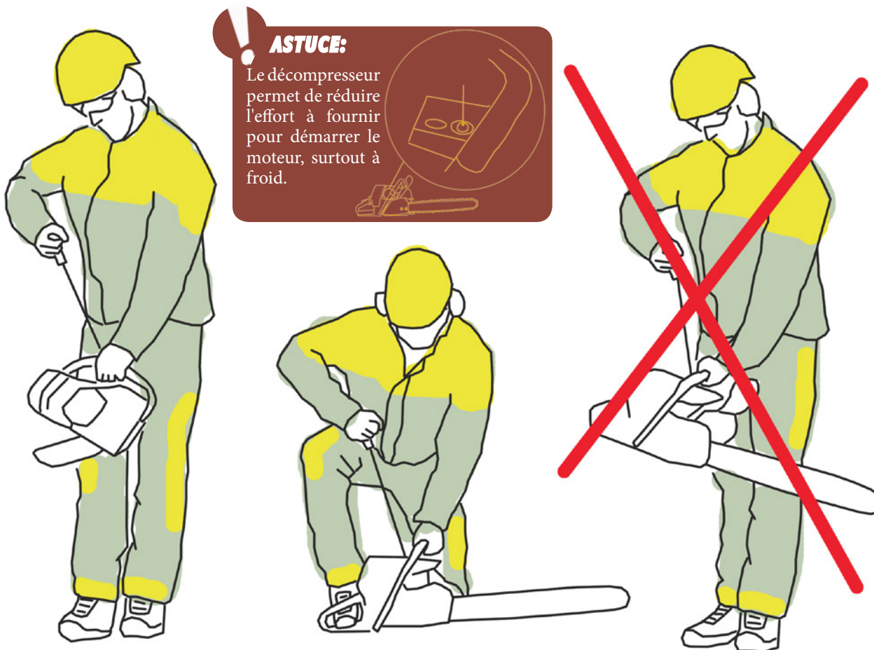
△ Positions correctes pour allumer une tronçonneuse △
