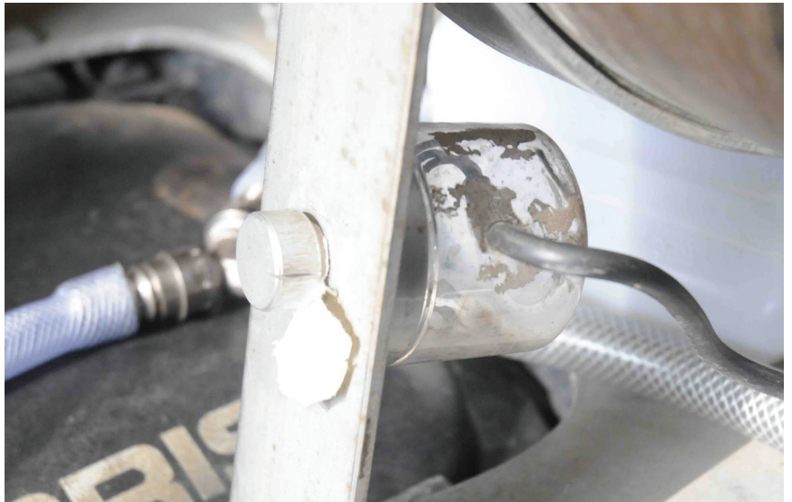
Le bouton de réglage est installé sur le support de la cuve arrière. Vincent a ses repères pour régler la bonne pression en fonction de la buse utilisée.
