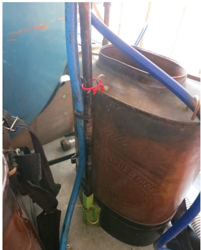
Vue de l'attache du Y sur la cuve
