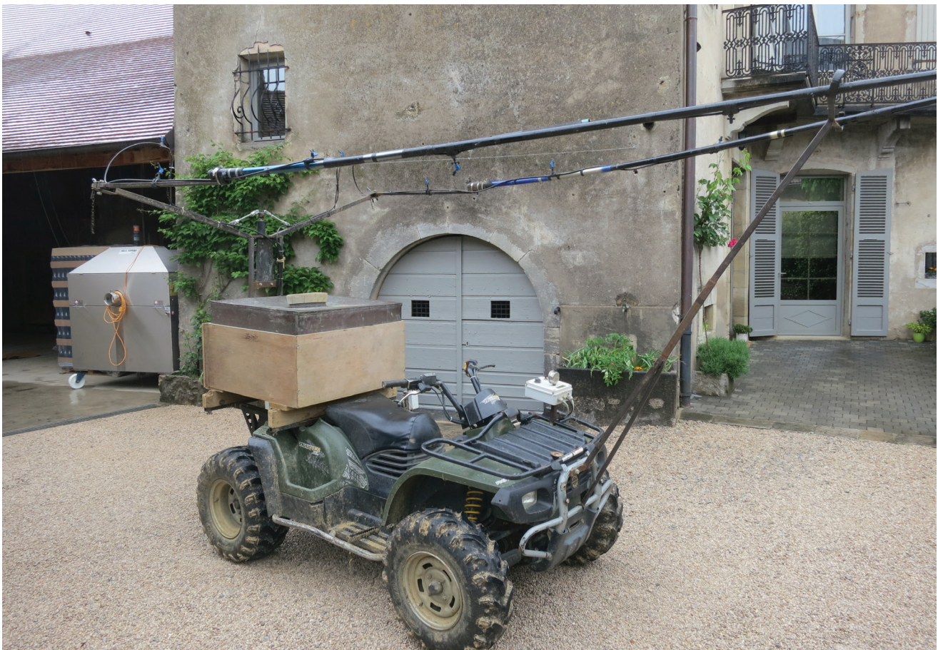
Vue globale du pulvérisateur monté sur quad
