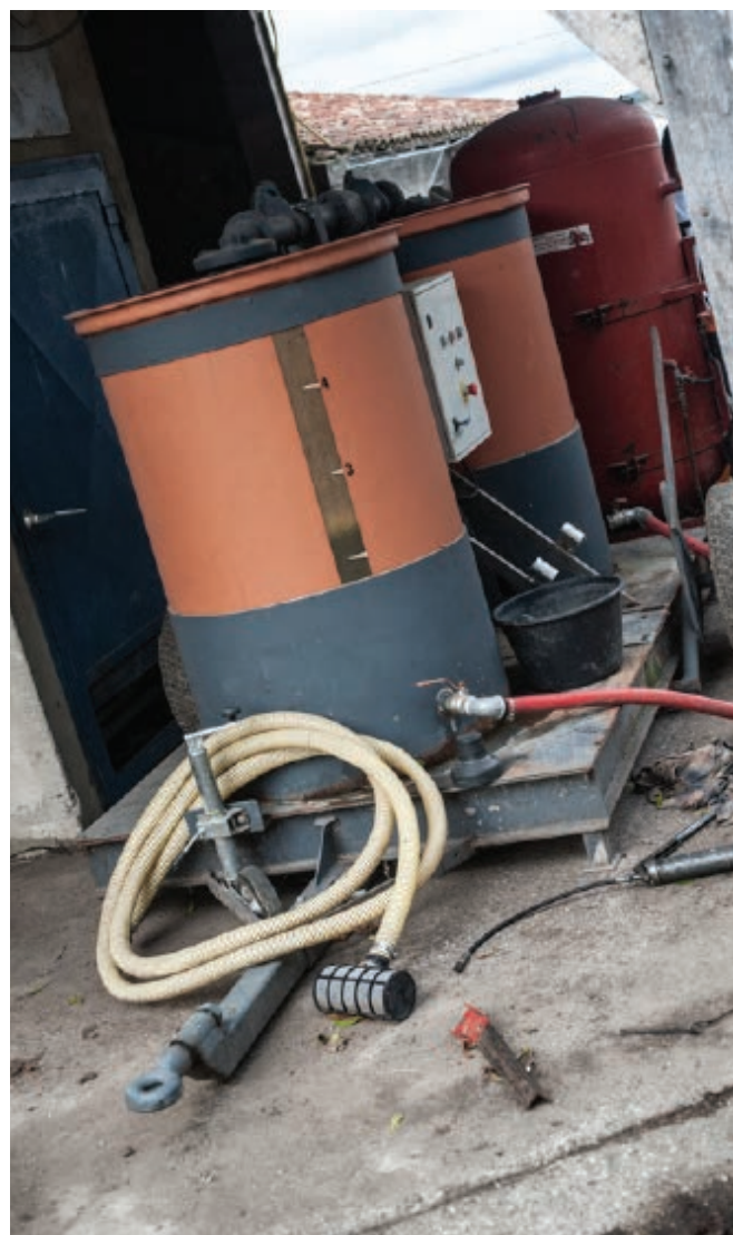
Vue d'ensemble du dynamiseur : les deux cuves montées sur la plateforme attelable
