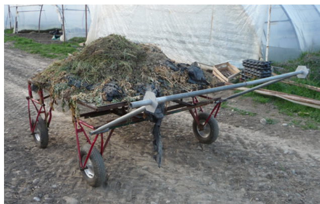
△ Barre pour déplacer le chariot (réglable en hauteur).
