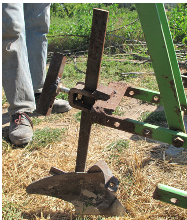
△ Vis de pression pour maintenir en place les outils.
