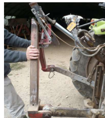
△ Troisième point hydraulique monté sur un triangle avec bascule.
