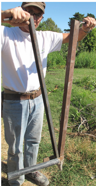
△ Vue d'ensemble de l'outil. Le tube en PVC fixé à la patte sert de repère pour mesurer l'écartement des plants (le paysan en a fabriqué plusieurs pour les différents types de culture).
