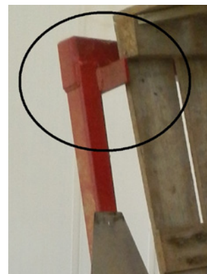
Détail : des cales ont été ajoutées afin d'éviter que le palox glisse.
