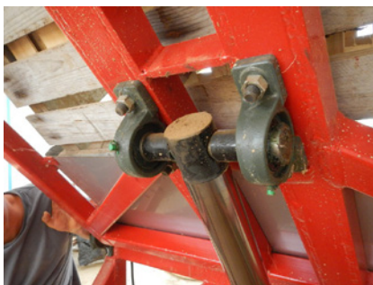
Détail : des cales ont été ajoutées afin d'éviter que le palox glisse.
