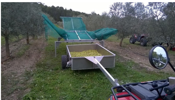
△ Buggy de récolte : la remorque, une fois pleine, est attelée au quad et transportée à l'effeuilleuse.
