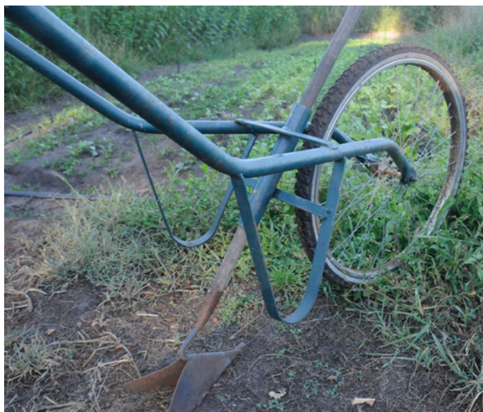
△ Vue d'ensemble : houe réalisée avec des bras de brouette.
