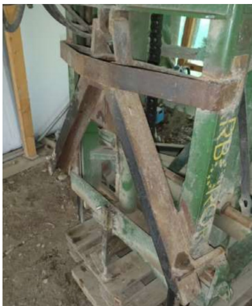
△ Fixation triangle femelle et renforts sur un outil lourd porté.
