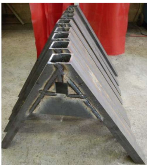
△ Triangles femelles autoconstruits.
