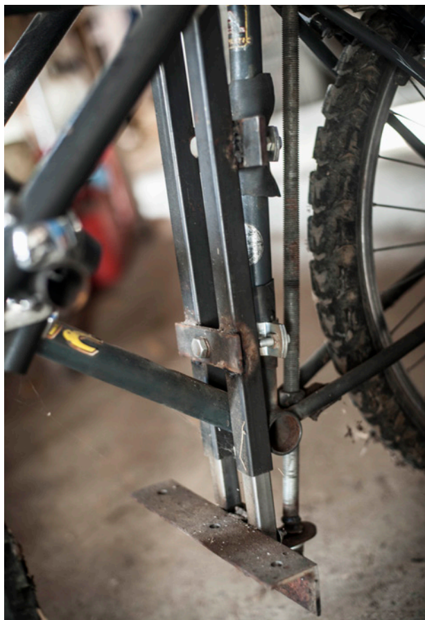
△ Détail de la translation et de la tige filetée.
