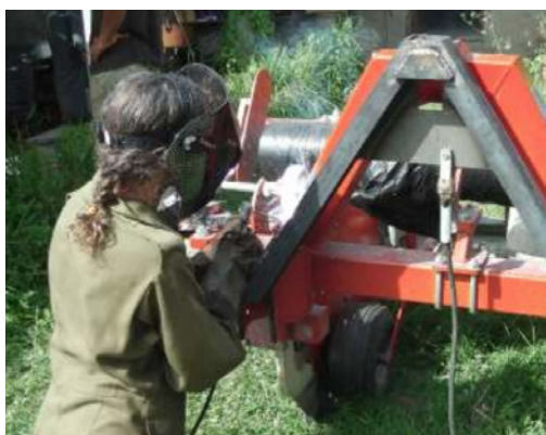
△ Fixation triangle femelle sur un outil.
