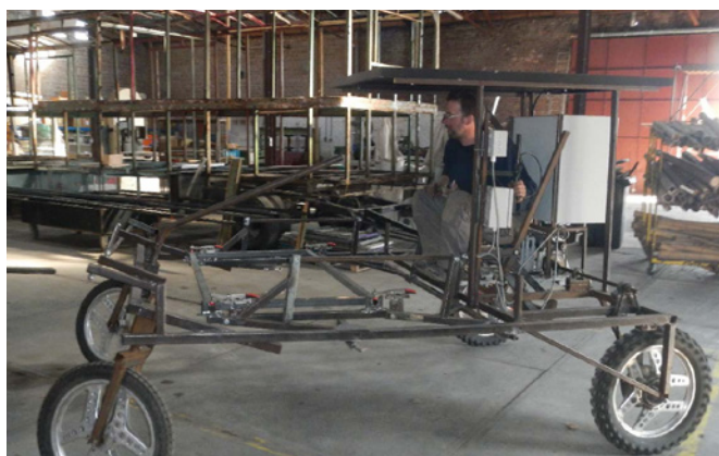
△ Assise et armoire électrique.
