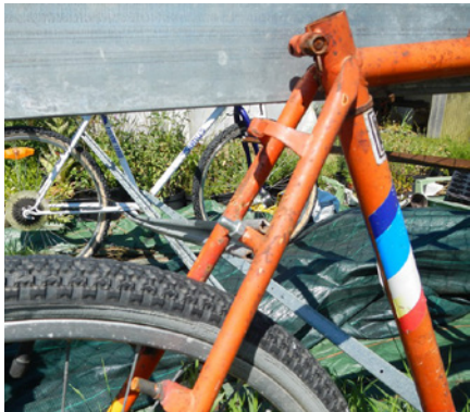
△ Détail du croisillon pour rigidifier la structure.
