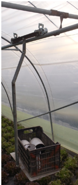
△ Détail pièce pour fixer le rail. ◁ Vue d'ensemble.
