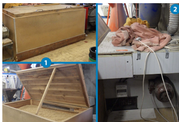
△ La touraille conçue est composée de deux entités principales : le séchoir (1) et la soufflerie (2).
