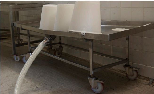
△ Cette table de mise en forme est mobile, elle se met sous la cuve pour pouvoir former les fromages. On voit le tuyau qui récupère le petit lait. Celui-ci est évacué directement par gravité jusqu'à la porcherie en contrebas de la fromagerie.
