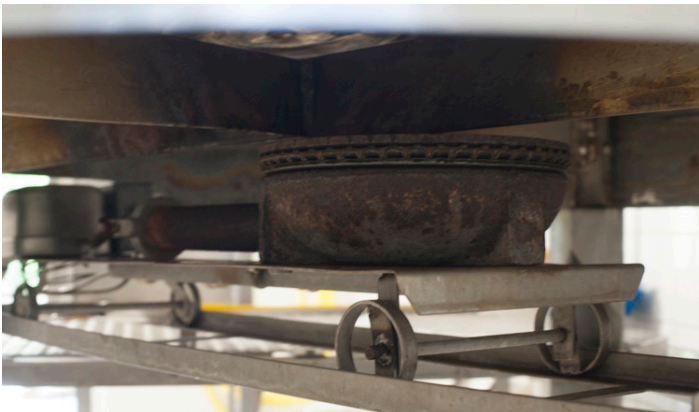
△ Cette table de mise en forme est mobile, elle se met sous la cuve pour pouvoir former les fromages. On voit le tuyau qui récupère le petit lait. Celui-ci est évacué directement par gravité jusqu'à la porcherie en contrebas de la fromagerie.
