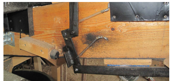
△ Les marteaux (en haut) et le système de ressorts (en bas).
