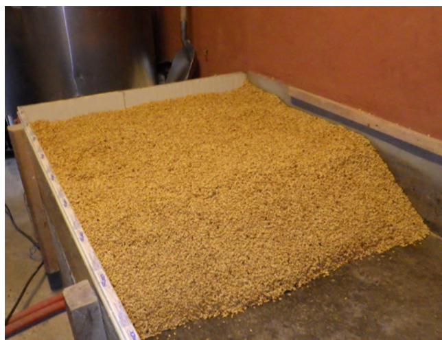
△ Vue de l'aire de germination : grains en phase de germination disposés en couche de 30 cm.
