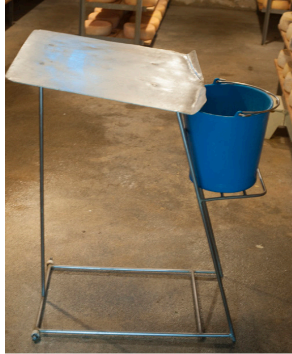
△ Une table sur roulettes avec un seau d'eau pour pouvoir frotter les fromages sans les porter.
