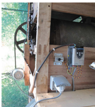
△ Moteur avec régulateur de vitesse Vue d'ensemble (à gauche) et ▶ sorties modifiées (à droite).
