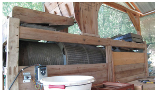
△ Moteur avec régulateur de vitesse Vue d'ensemble (à gauche) et ▶ sorties modifiées (à droite).
