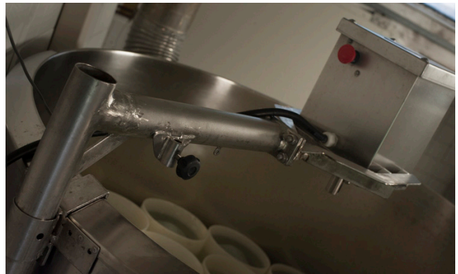
△ Le moteur de brassage de la cuve est monté sur une potence qui pivote ce qui permet de le repousser et d'accéder à toute la cuve pour le nettoyage.
